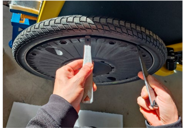
BILD 43 EINGRIFFPOSITION: HEBELN IM BEREICH ZWISCHEN DEN FELGENSCHRAUBEN
