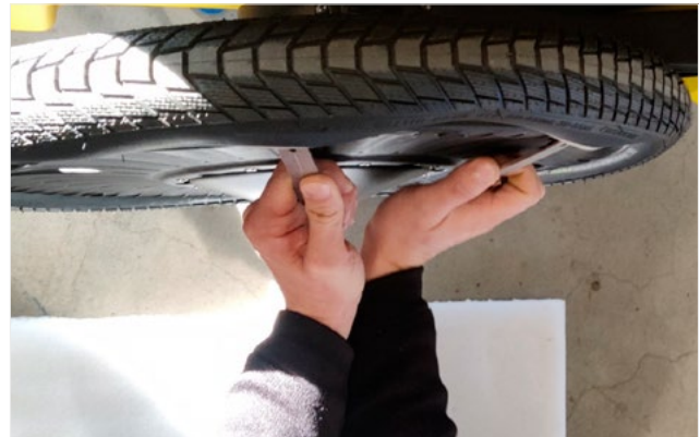
BILD 44 DEN REIFEN RINGSUM EINSEITIG HERAUSHEBELN
