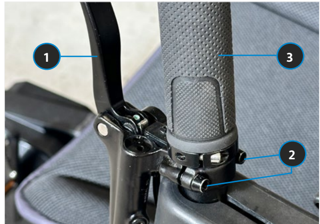
BILD 19 BREMSHEBEL EINSTELLEN (BSP. RECHTS)
