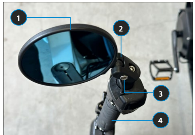
BILD 18 SEITENSPIEGEL EINSTELLEN (BSP. RECHTS)
