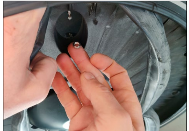
BILD 45 VENTIL DURCH VENTIL-ÖFFNUNG FÜHREN UND FELGENMUTTER LOSE BEFESTIGEN
