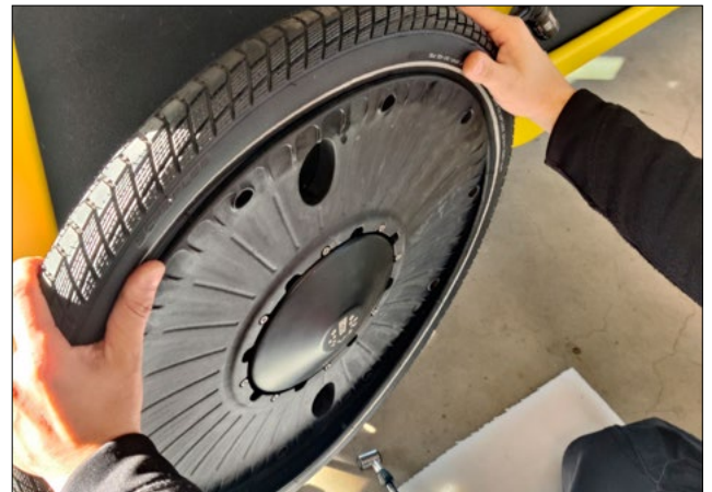
BILD 46 MANTEL RINGSUM VON HAND EINFÜHREN
