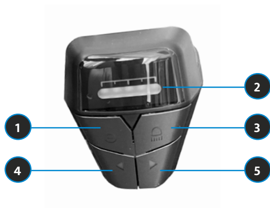
BILD 6 ÜBERSICHT BEDIENELEMENT AVS RC 9, RECHTS 1 An- und Aus Taster 4 Unterstützungsstufe: „runter/weniger“ Nummernwechseltaster „runter/weniger“ Gehhilfe öffnen 2 LED Statusanzeige 5 Unterstützungsstufe: „hoch/mehr“ Nummernwechseltaster „hoch/mehr“ Gehhilfe aktivieren (gedrückt halten) 3 Licht Ein- und Aus (lang gedrückt halten) Bestätigungstaster Menüeinstellungen
